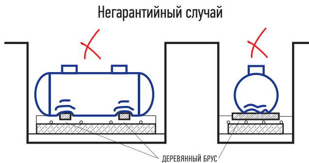
Рис. 11. Запрещенный вариант размещения емкости на опорной плите
